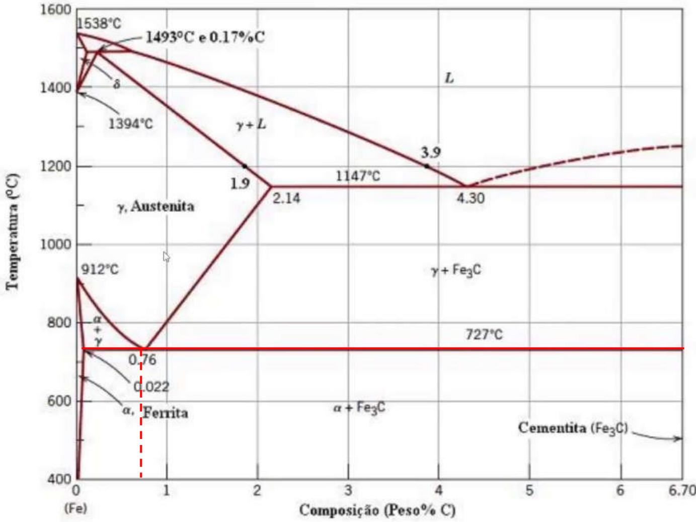
A Perlita é o componente eutetóide do aço.
